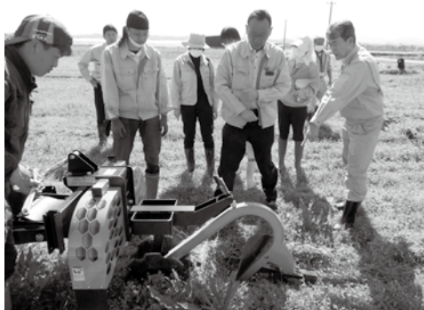
掘る深さの調整を行う関係者
